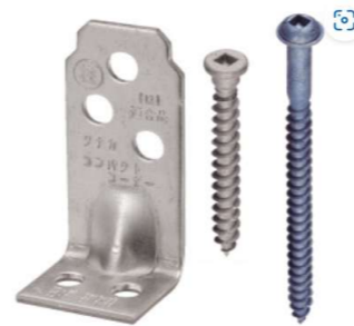
専用角ビットビス 柱面TB-55(使用本数3本) 横架材面TB-101(使用本数2本)
